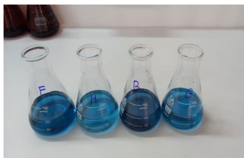
Figure 22 : Titrage colorimétrique de l'ion ammonium donnant changement de couleur indiquant le point d'équivalence.
