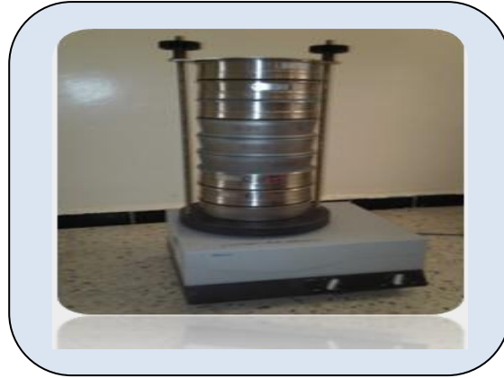
Figure 19: Le dispositif de tamisage des sédiments : Tamiseuse électrique.
