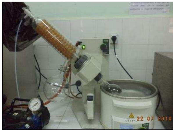
Figure 12 : Récupération du solvant.
