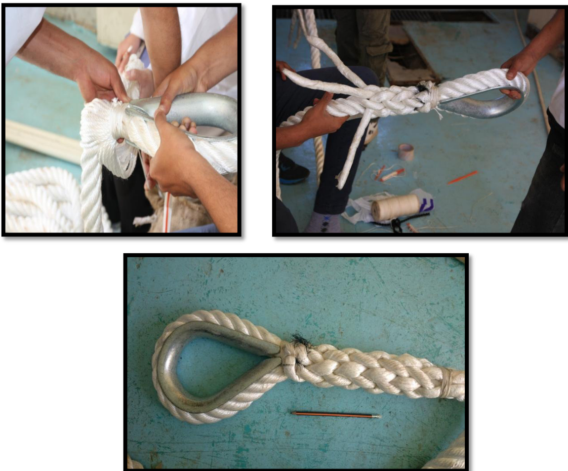
Figure 21 : Des photos présentent le cordage d'une épissur.
