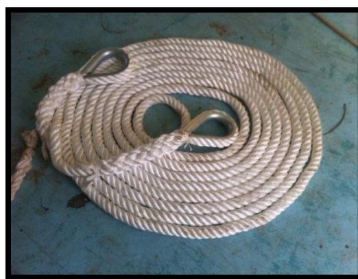
Figure 30 : Aussière en polypropylène Ø45mm, 30m.
