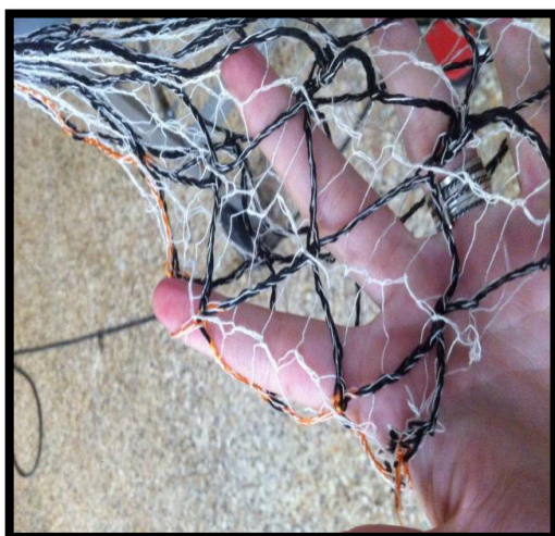
Figure 40 : Filet tubulaire biodégradable.
