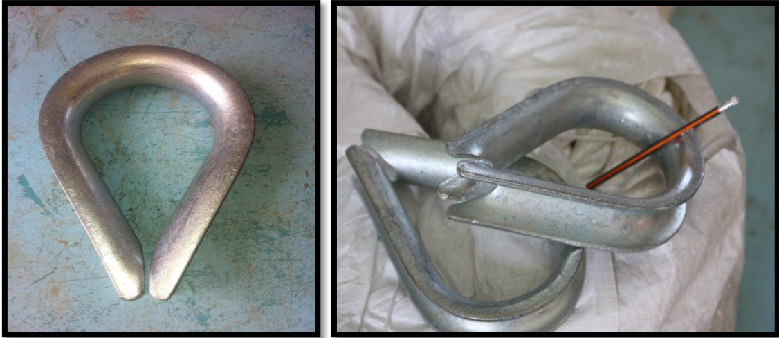
Figure 20 : Des cosses-cœurs de diametre 45mm.
