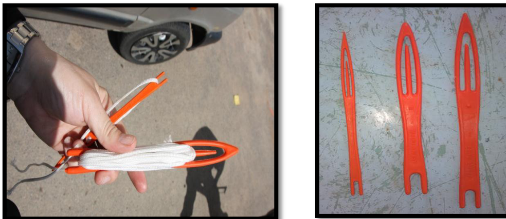
Figure 23 : Les aiguilles de différentes tailles utilisées pour attacher les torons avec les surliures
