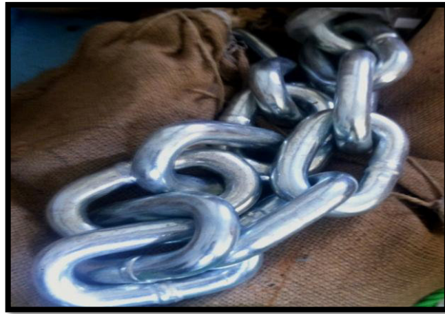
Figure 24 : Une chaine en acier ( \varnothing 25mm×5m).
