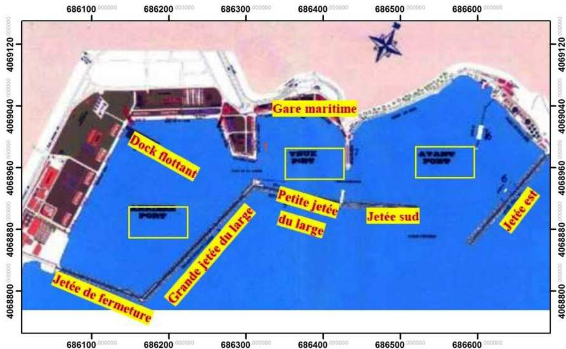
Figure II.7 : Les ouvrages du port de Bejaia (Entreprise Portuaire de Bejaia, 2007).
