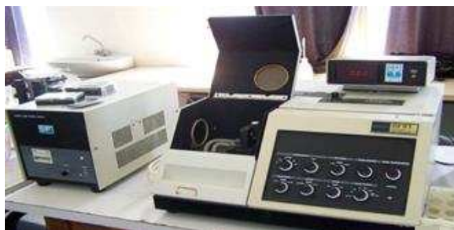
Figure III.27: Spectrophotomètre de Fluorescence HITACHI, modèle 650 S, équipé d'une lampe « Xénon ».
