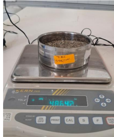
Figure 14 : Détermination des poids des échantillons après séchage à 50°C pendant 24h
