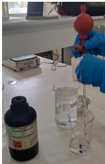
Figure. 19 :Digestion de la matière organique par l'ajout de Peroxyde d'hydrogène H_2O_2
