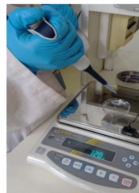
Figure 17.verification de la densité de la solution NaCl
