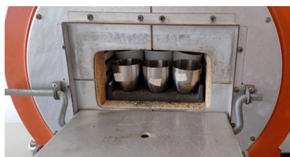
Figure .38 : Calcination des échantillons à 480°C
