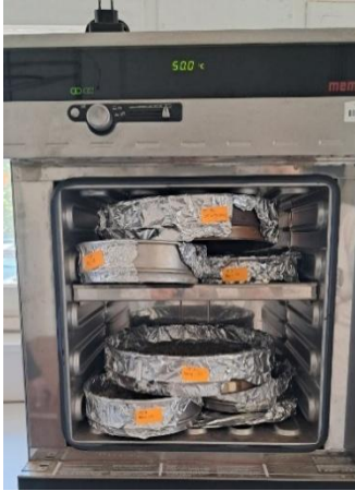
Figure 14 : Détermination des poids des échantillons après séchage à 50°C pendant 24h
