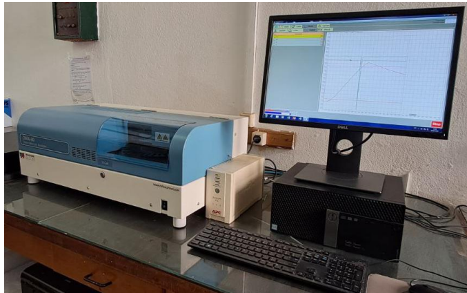
Figure. 23 :Analyseur de mercure totale DMA-80 Tri Cell
