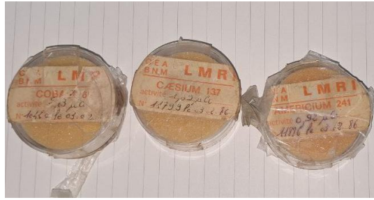
Figure.1 .32 : Sources radioactives utilisées pour l'étalonnage Am-241, Cs-137,Co—60
