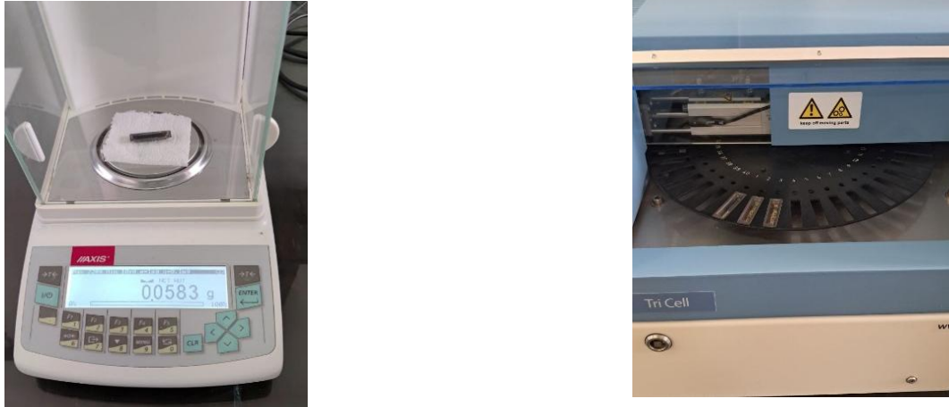
Figure. 25 :Pesage et introduction des échantillons dans l'analyseur
