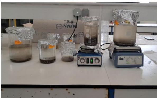
Figure 16 .Agitation des échantillons après l'étape de séparation par densité
