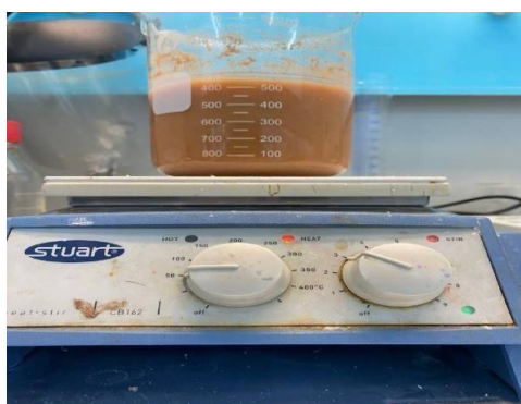
Figure 11 : Déminéralisation des carapaces de crevettes par HCl
