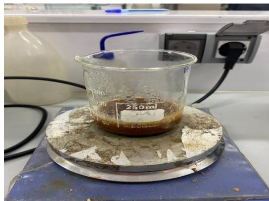
Figure 12 : Etape de déprotéinisation des carapaces de crevette par NaOH (2N)
