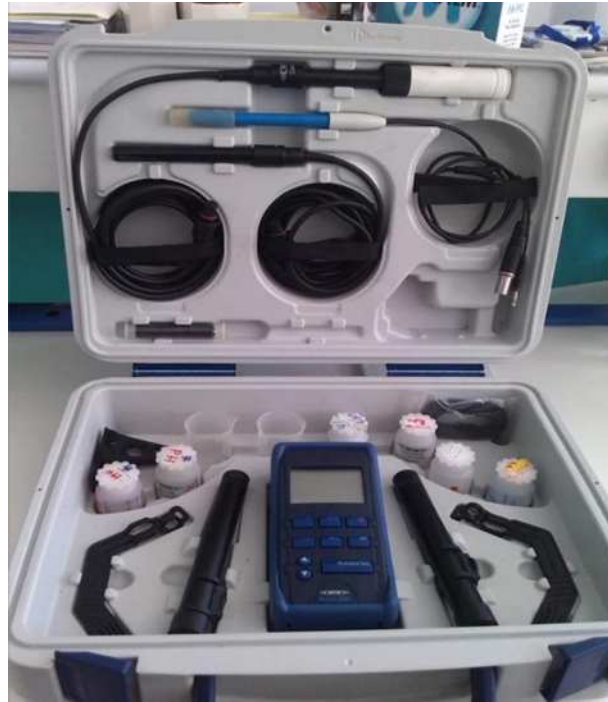
Figure 6 : Valise multiparamétrique WTW Multi 340i SET
