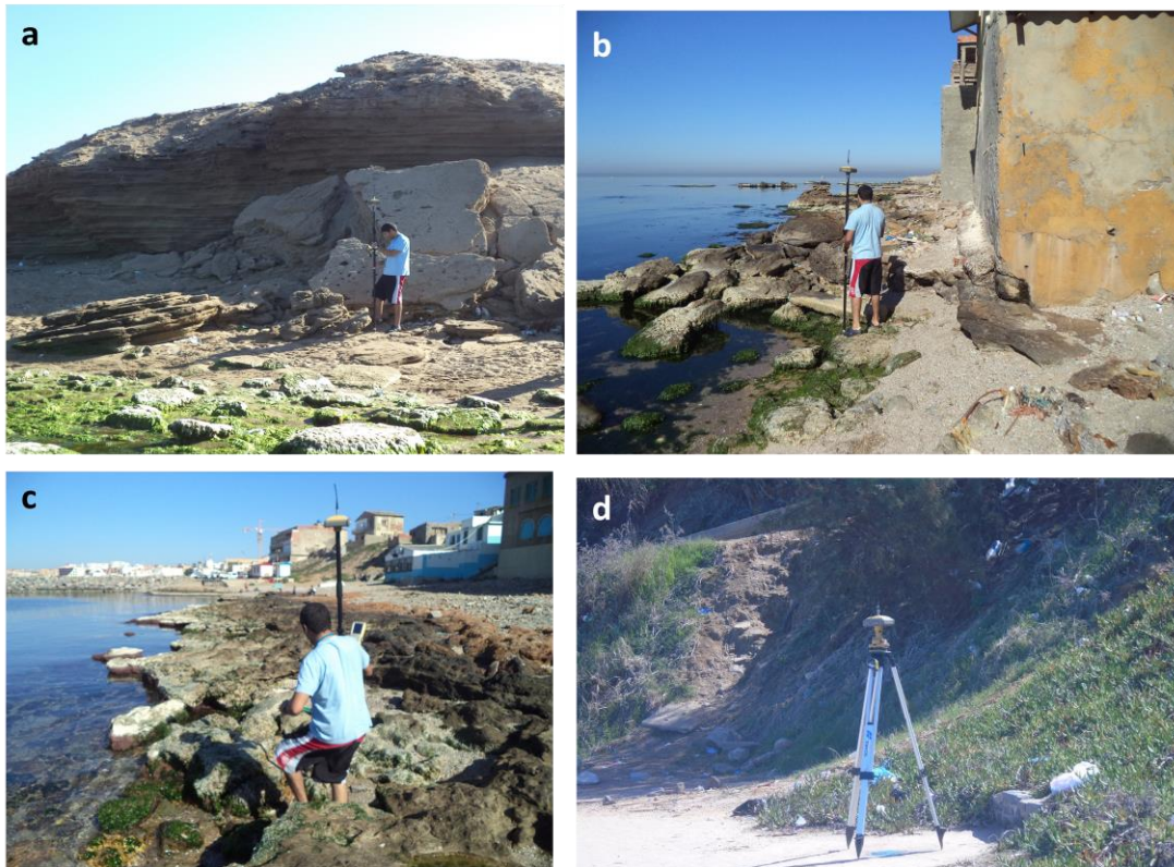
Figure III-12 : a : Perte de signal du à un obstacle naturel et b : Perte de signal du à un obstacle artificiel, c : Terrain dégagé mais escarpé, d : Terrain à risque de mouvement.
