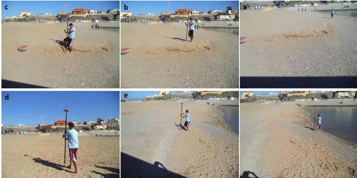
Figure III-27 : a, c, b, c, d, e et f : Elaboration des model numérique de terrain.
