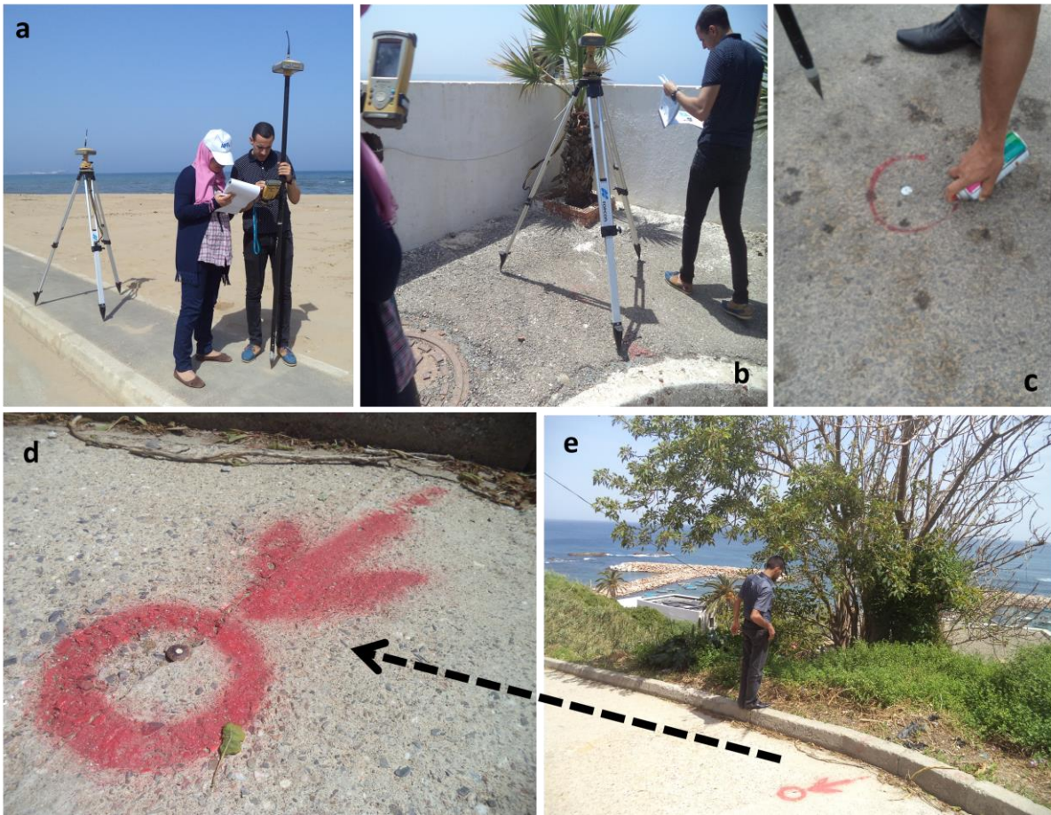
Figure III-14 : a et b : Contrôle de terrain, c, d et e : Marquage et signalisation des points géodésiques.
