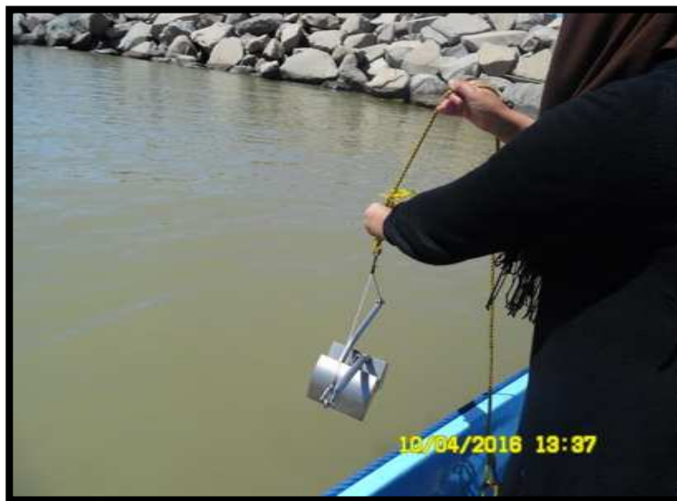
Figure n° III.02 : Prélèvement des sédiments à l'aide d'une benne de type Van Veen
