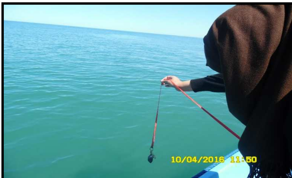
Figure n° II.07 : Mesure des profondeurs par un filet métallique gradué
