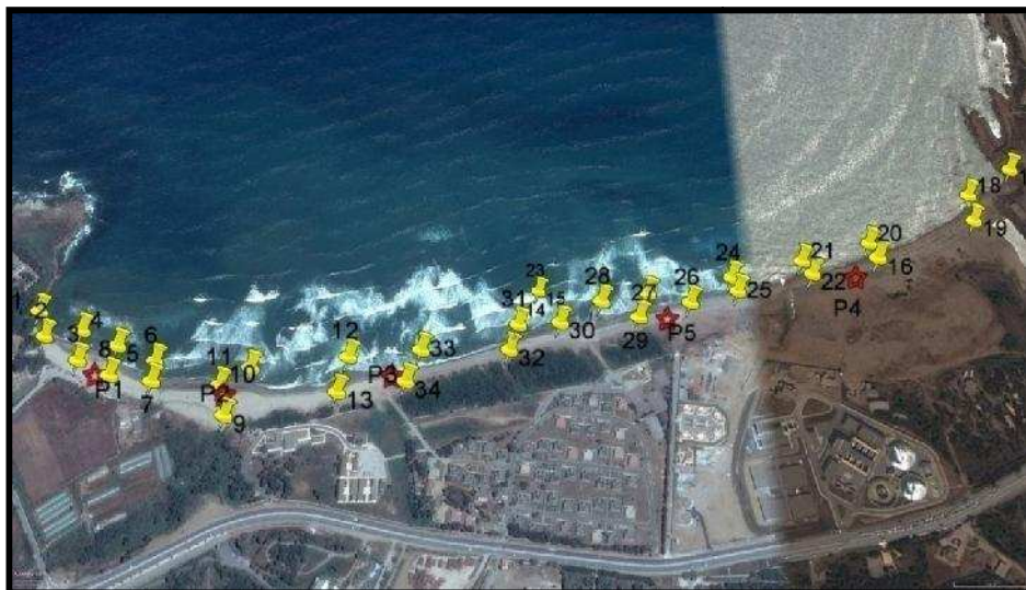
Photo : Les postions de la mire et de théodolite dans la plage Ondreu 1
