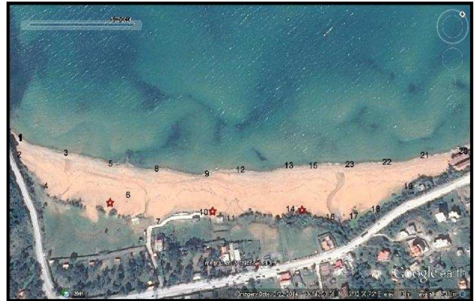
Photo : Les postions de la mire et de théodolite dans la plage de Les Aftis
