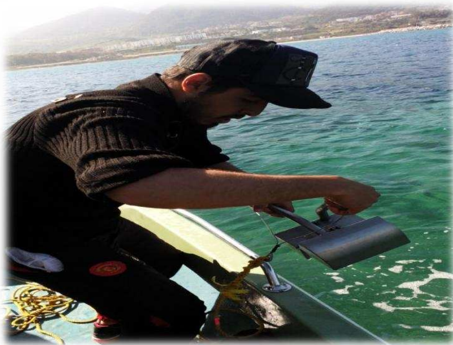
Figure 30 : Prélèvement des sédiments à l'aide d'une benne de type Van Veen
