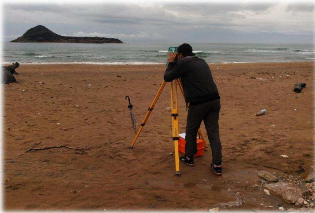
Figure 45 : Utilisation d'un théodolite pour le traçage du trait de côte
