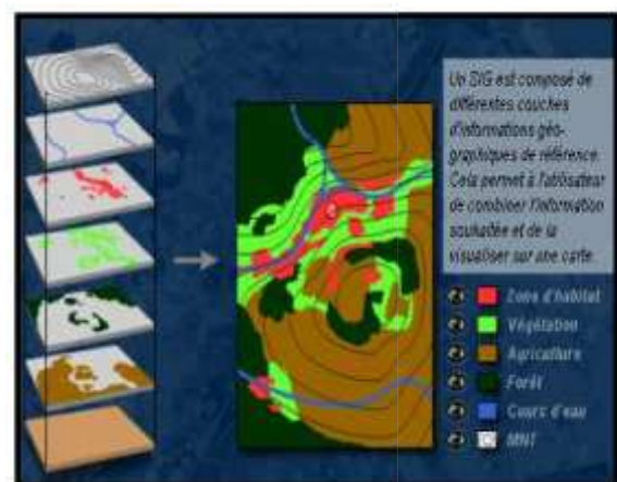
Figure 10: Superposition de différentes couches d'information dans un SIG
