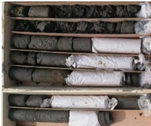
Figure 10 : Photo montrant des carottes de marnes grises du Plaisancien, sondage 10 [JICA, 2006].
