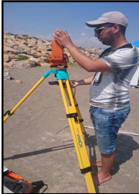
Photo 8 : installation et la prise des coordonnées du théodolite.
