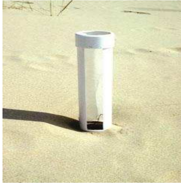
Figure 12. Piège à sable verticale de type Leatherman
