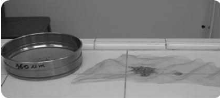
Figure 14. Photographie du Comparaison entre la maille de tissu et la maille d'un tamis (160 \mu\text{m} ) (Bourahla H., Sakhri S., 2013)
