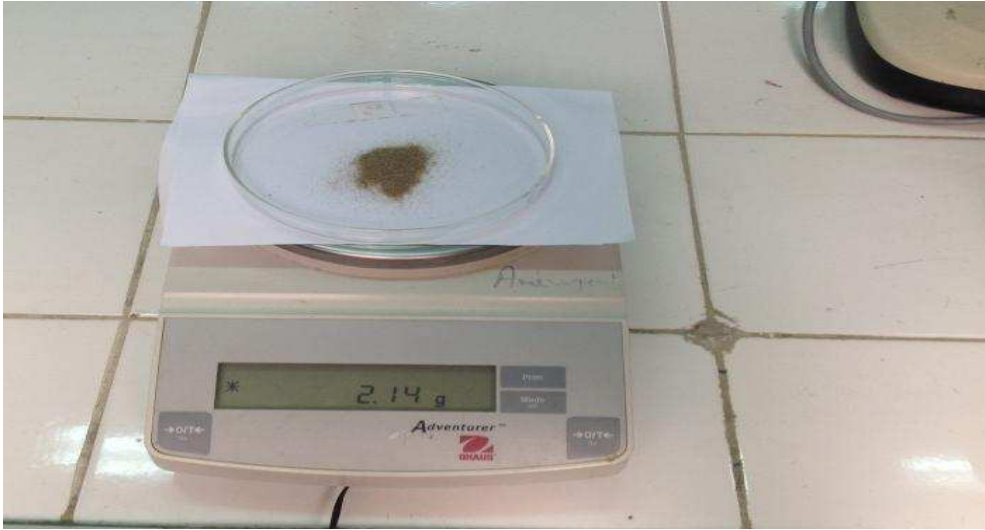
Figure.21. mesure la quantité du sable capté par le piège Leatherman (Bourahla H., Sakhri S., 2013)
