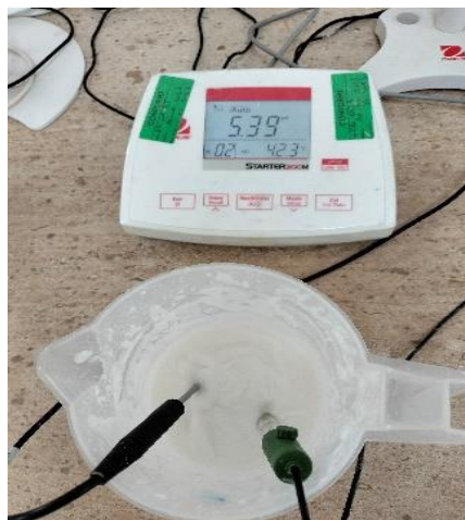
Figure II.29 pH-mètres de type « OHAUS-STARTER 3100 M ».
