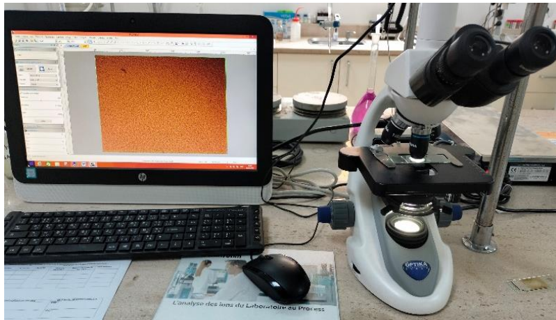
Figure II.33 Microscope photonique à caméra intégré (G X 40)
