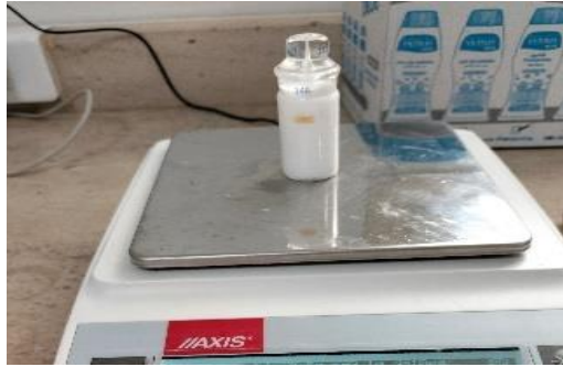
Figure II.31 Mesure de densité par un pycnomètre
