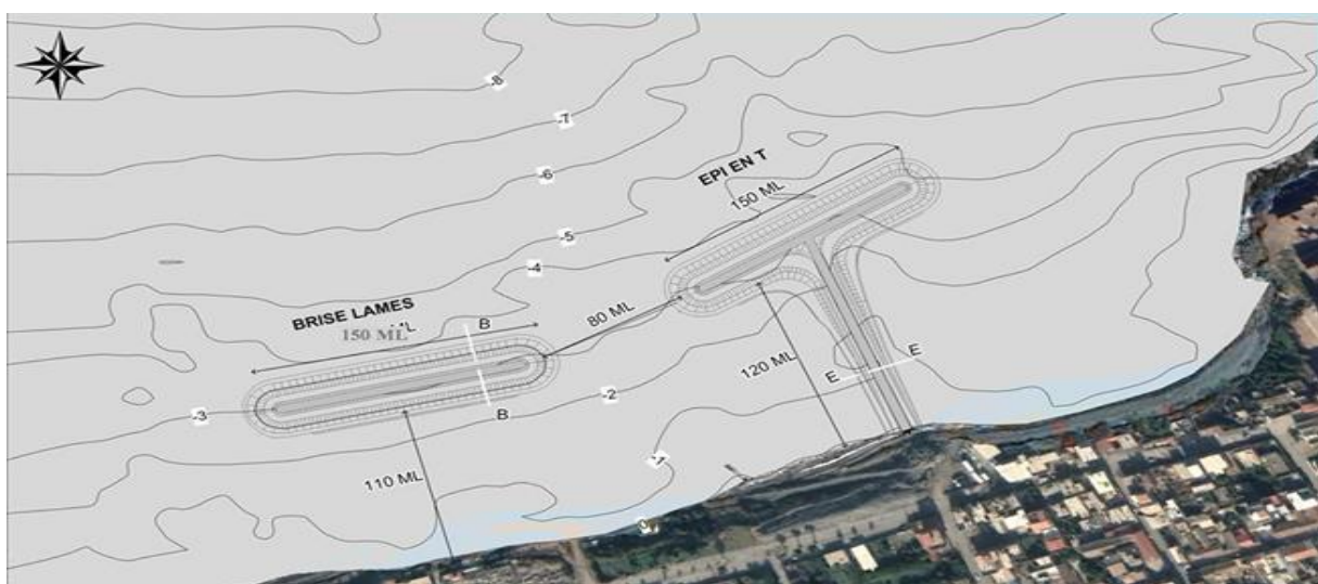
Figure IV. 5 : Emplacement de brise-lames et épi immergés en enrochement. (Mehareb et Boussaidi 2019).
