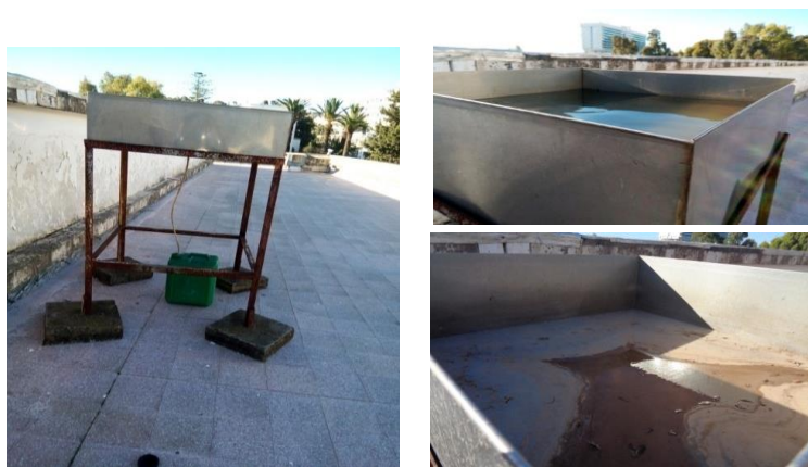
Figure II.6: Table de collecte des dépôts installée au site d'Alger
