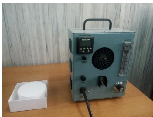
Figure II.5 : Préleveur d'aérosol installé au site de Chréa ainsi que le filtre utilisé
