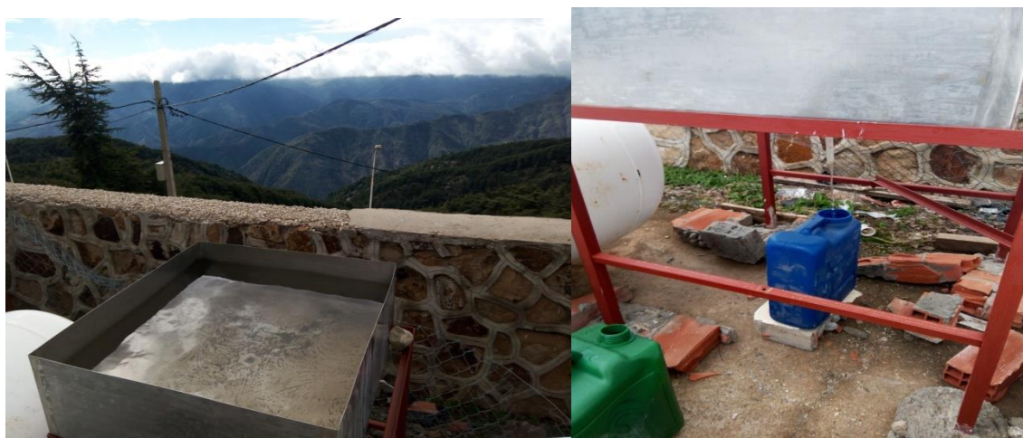
Figure II.7: Table de collecte des eaux de pluies et particules install e   Chr ea.
