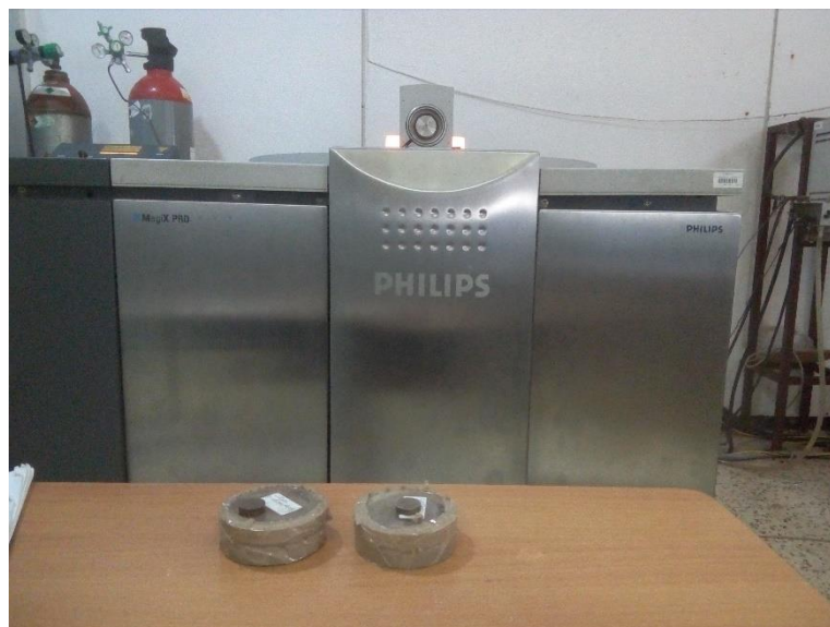
Figure II.26: Spectromètre à rayons X Magix pro accompagné des pastilles des échantillons.
