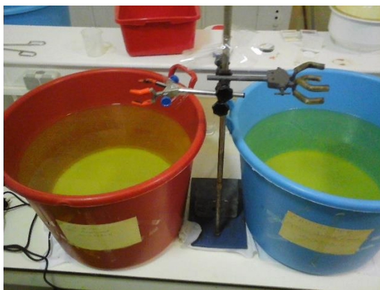
Figure II.15: Traitement radiochimique des eaux de pluies par l'opération de co-précipitation d'AMP
