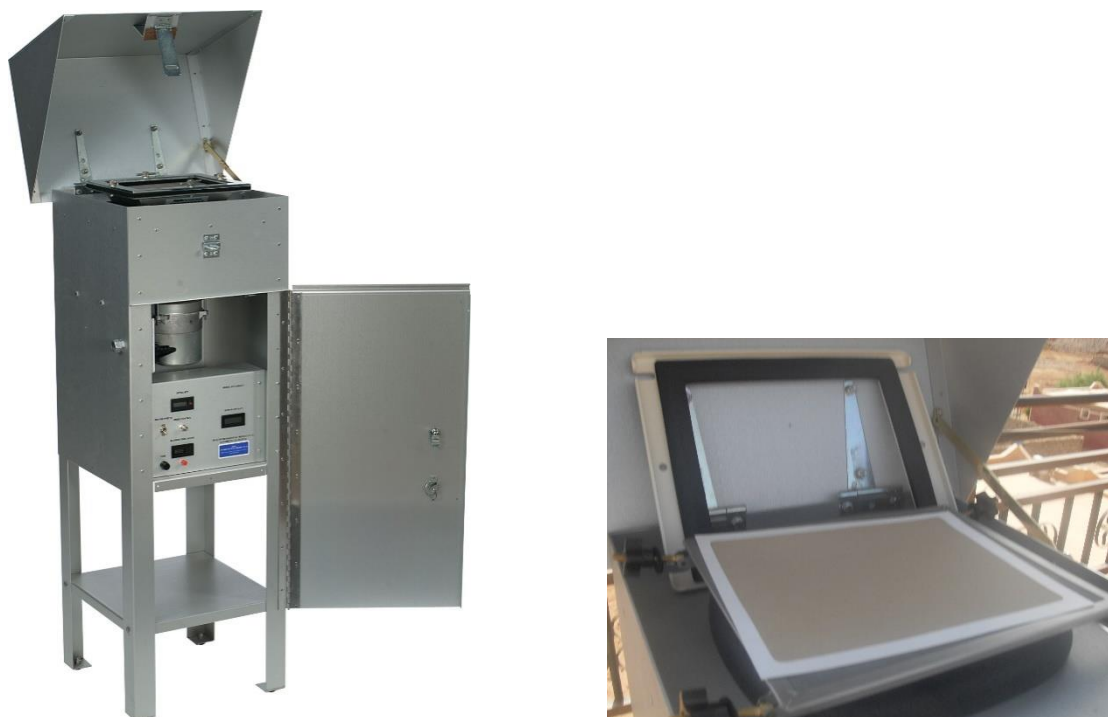
Figure II.4:Préleveur d'aérosols ayant un débit moyen de 67.9 \text{ m}^3/\text{h} ainsi que le filtre utilisé.
