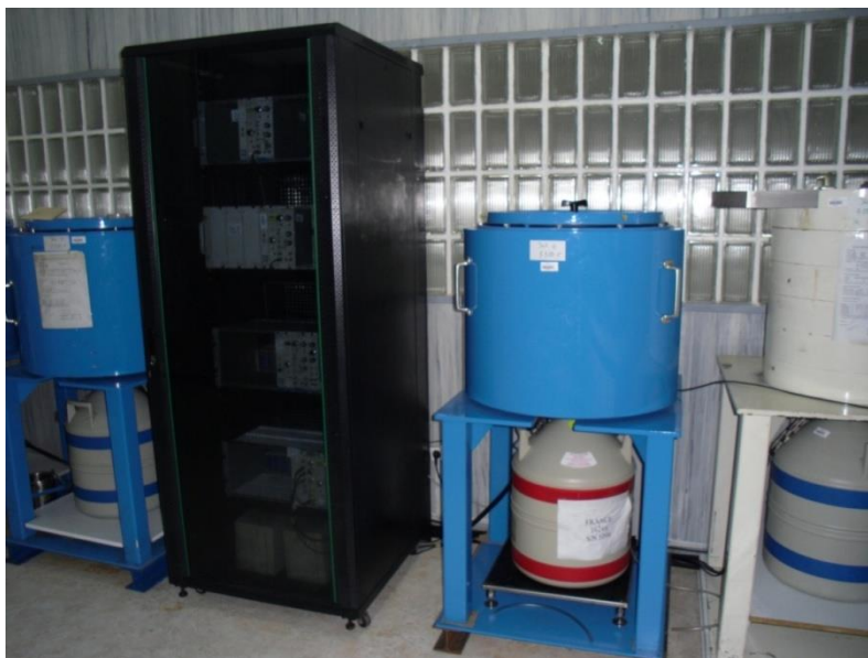
Figure II.20: Chaînes de spectrométrie gamma (GeHP) utilisées au laboratoire de l'environnement du CRNA
