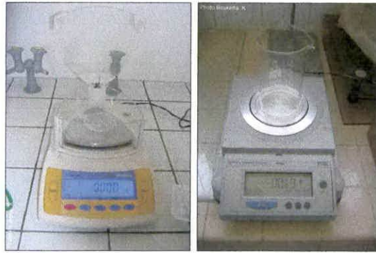
Figure 27 : balance pour le pesage des alevins (photo de gauche) Figure 28 : balance pour le pesage des géniteurs (photo de droite)
