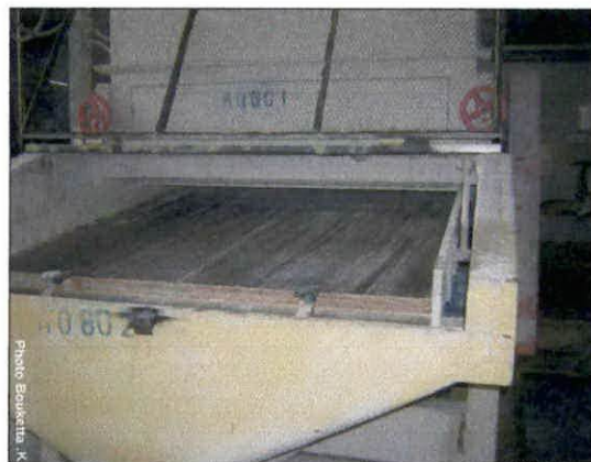
Figure 16 : Les émiettés sortent de la tamiseuse, UAB Oued Tlelat.
