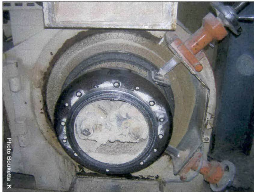
Figure 14 : La presse à granulés de Oued Tlelat.
