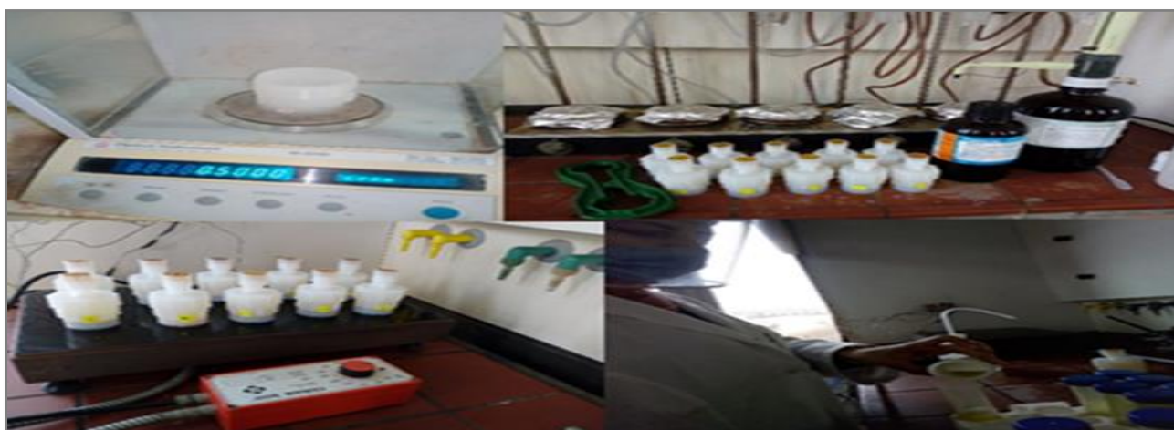
Figure 23 : Etapes de la minéralisation des échantillons
