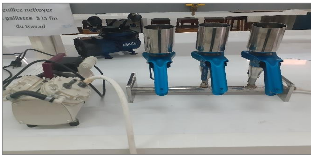
Figure 16 : Rampe de filtration de marque Millipore
