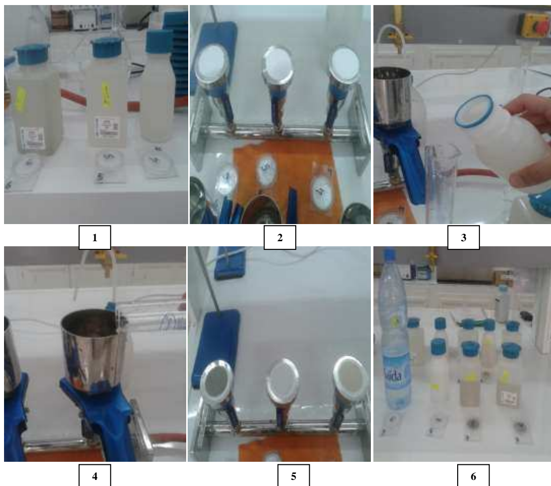
Figure 28: Etapes de la filtration des échantillons pour la mesure de MES.
