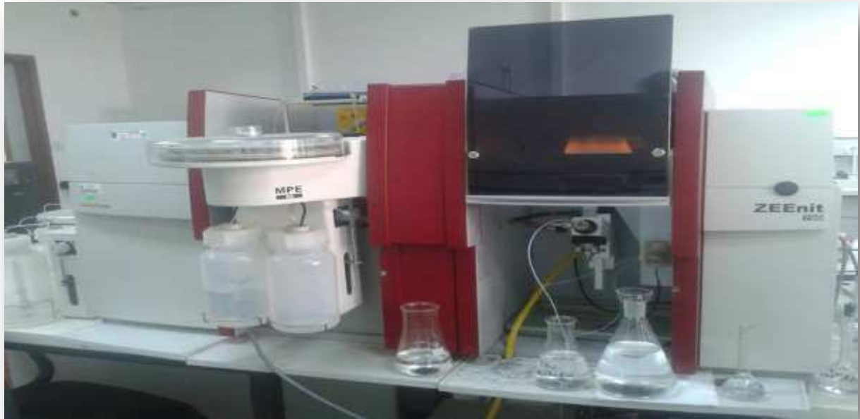
Figure 16 : Appareil de spectroscopie d'absorption atomique utilisé.
