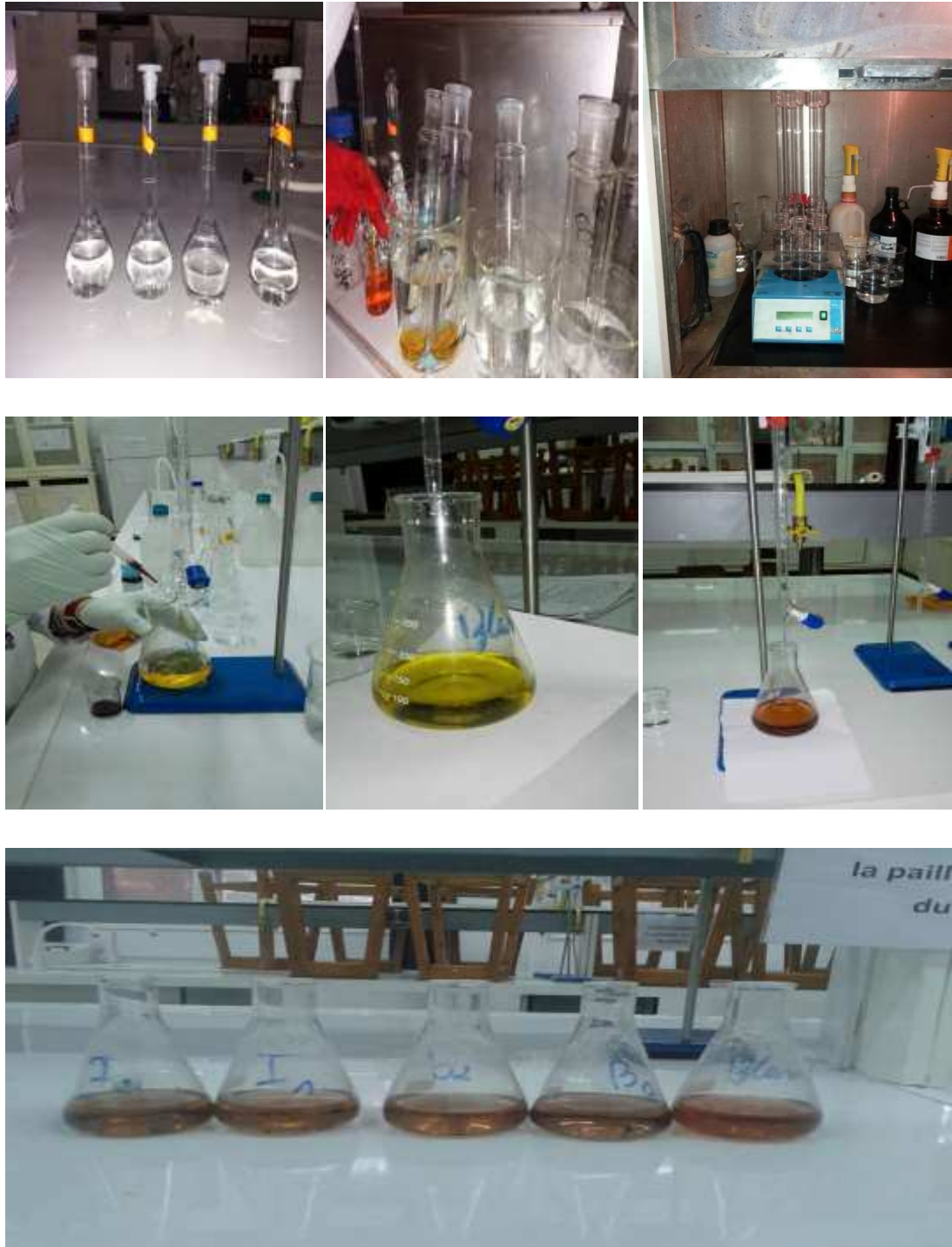
Figure 29: Quelques étapes lors de la manipulation de la DCO.
