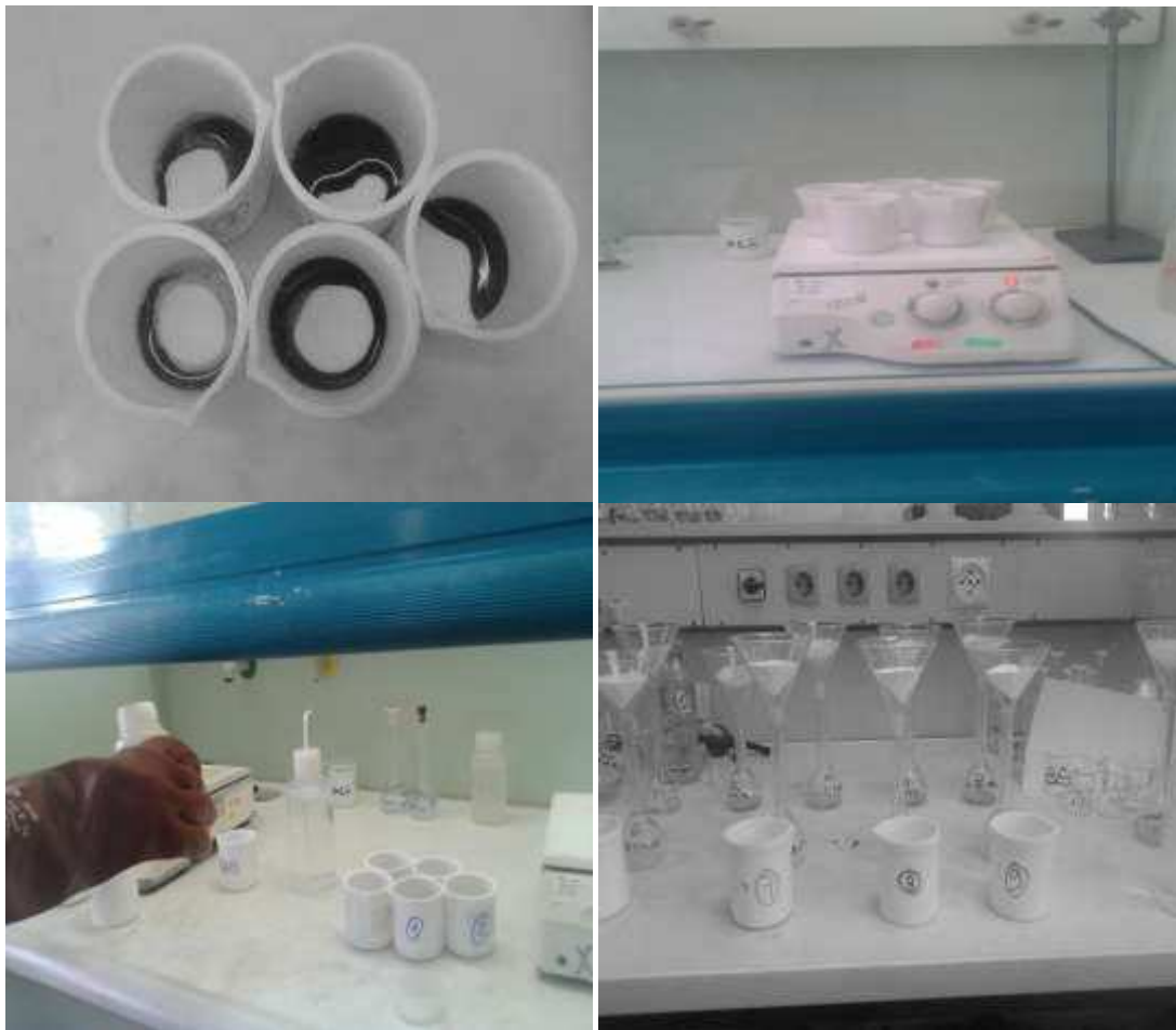
Figure 30: Minéralisation d'échantillons de sédiments.
