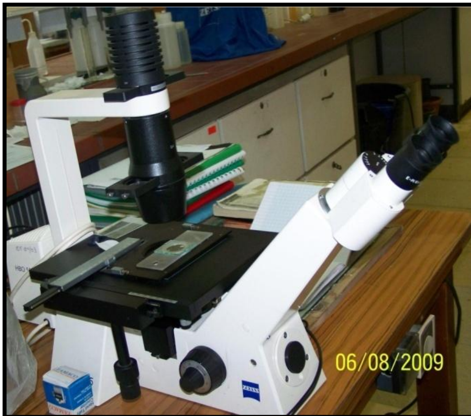
Figure 4: Photo du microscope inversé (Zeiss HBO 50/AC Axio vert 25 équipé d'une caméra HRC) du laboratoire d'écosystème pélagique de la Faculté des Sciences Biologiques de l'USTHB.
