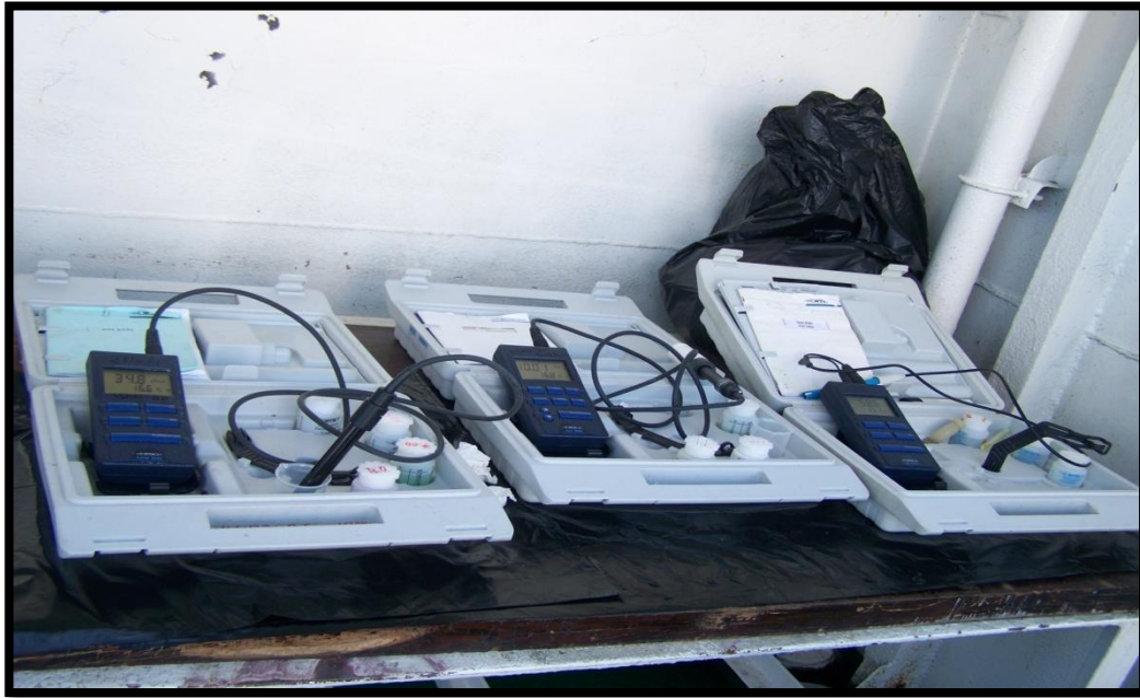
Figure 15: Photos des valises multiparamètres utilisées à bord du bateau.
