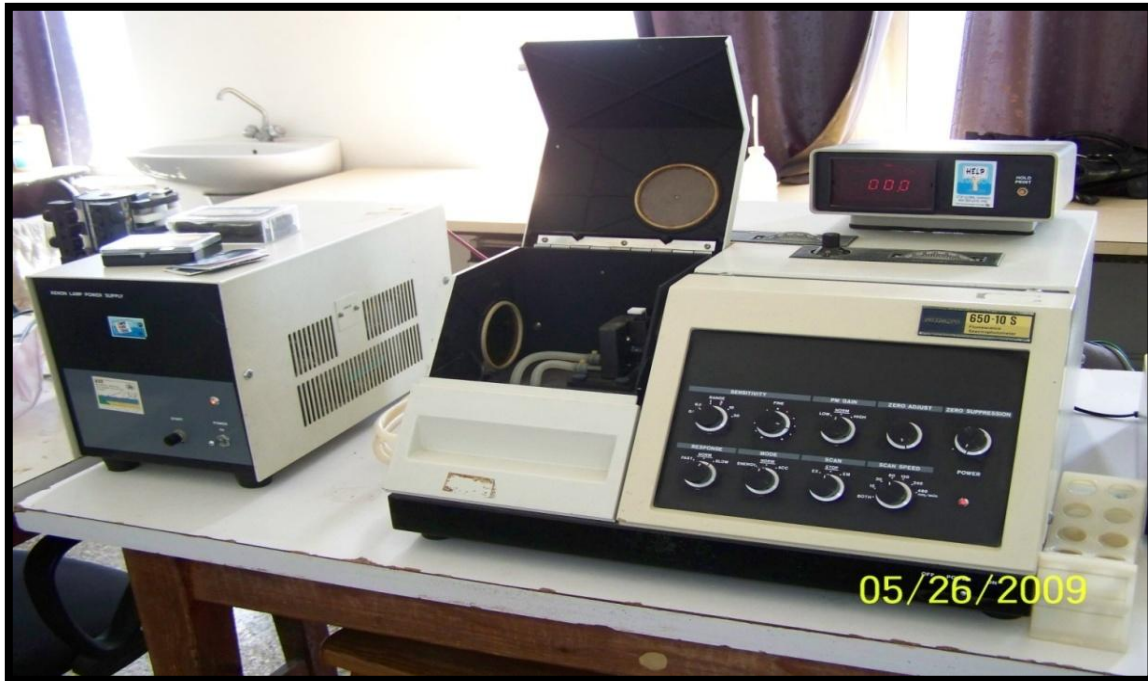
Figure 3: Photo du spectrophotomètre de Fluorescence HITACHI, modèle 650 S, équipé d'une lampe « Xénon ».
