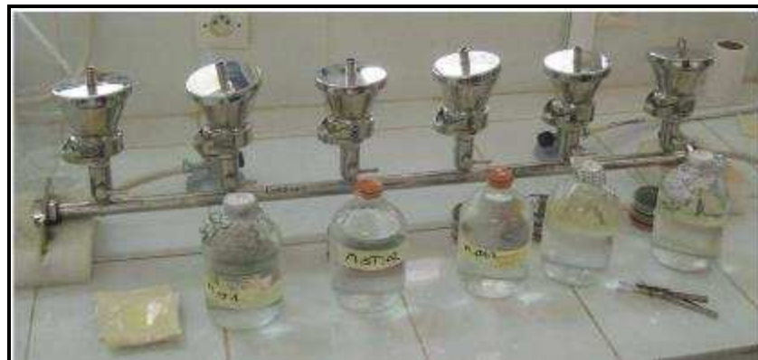
Figure n° 4.1: Dispositif de l'appareil de filtration sur membrane.
