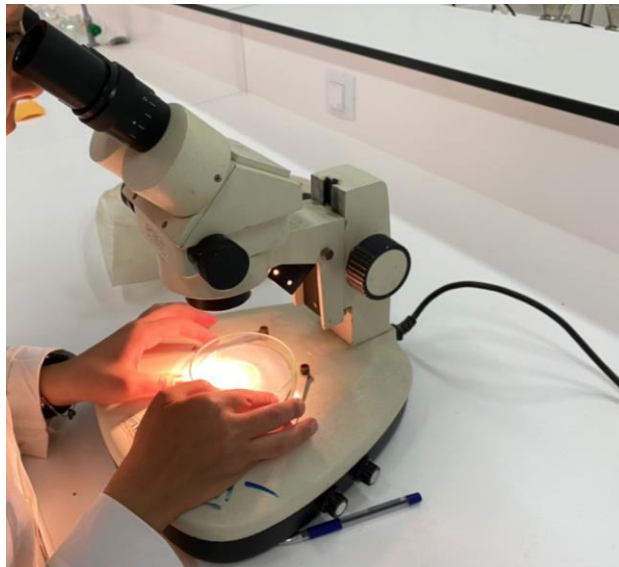
Figure 24 : Identification des microplastiques sous la loupe binoculaire
