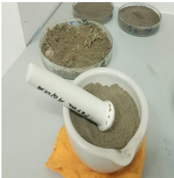
Figure 29 : Meulage de sédiments collés dans le mortier
