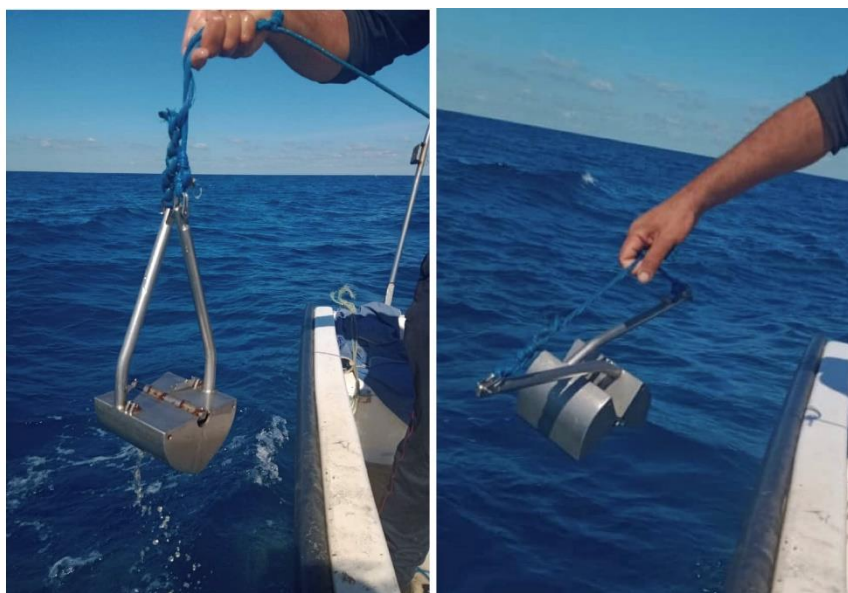
Figure 21 : Benne Van Veen en cours de prélèvement
