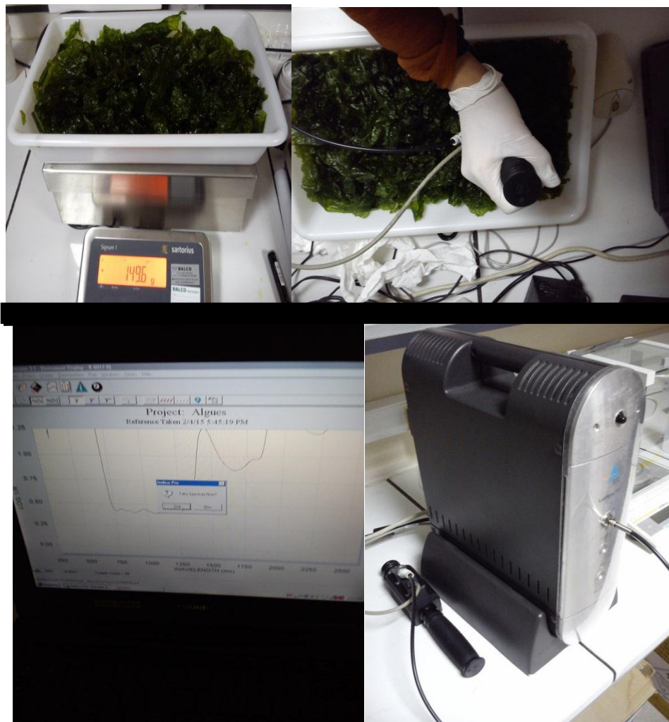
Figure 17 : Prédiction de la teneur en azote total par SPIR dans des échantillons d'ulves fraîches.
