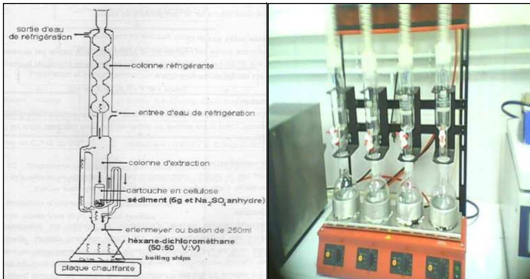
Figure 3.4 : Un extracteur Soxhlet
