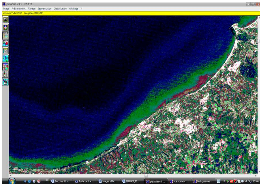
Figure 4.45 : Spatialisation des hydrocarbures polyaromatiques. Image Landsat TM1 de la baie de Bousmaïl transformée à partir de la relation \text{Réf (TM1)} = -3\text{E-}10\text{HPA}^5 + 2\text{E-}08\text{HPA}^4 - 3\text{E-}07\text{HPA}^3 + 2\text{E-}06\text{HPA}^2 - 4\text{E-}06\text{HPA} + 0,1061
