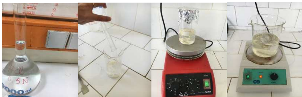
Figure 20 : préparation de la solution de chitosane.
