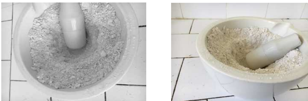
Figure 23 : Broyage de la diatomite à l'aide d'un mortier en porcelaine.
