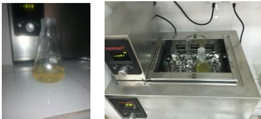
Figure 33 : Bain thermostaté avec agitation
