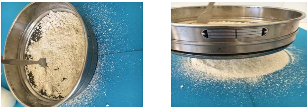
Figure 24 : Tamisage à l'aide d'un tamis en INOX.
