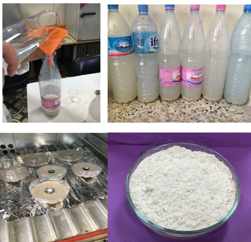
Figure 25 : Etapes d'élimination de la silice quartz de la poudre de diatomite
