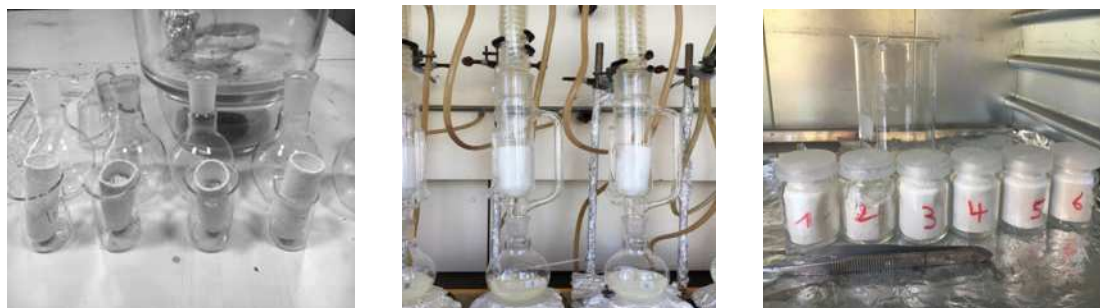
Figure 27 : extraction de la calcite contenue dans la poudre de diatomite
