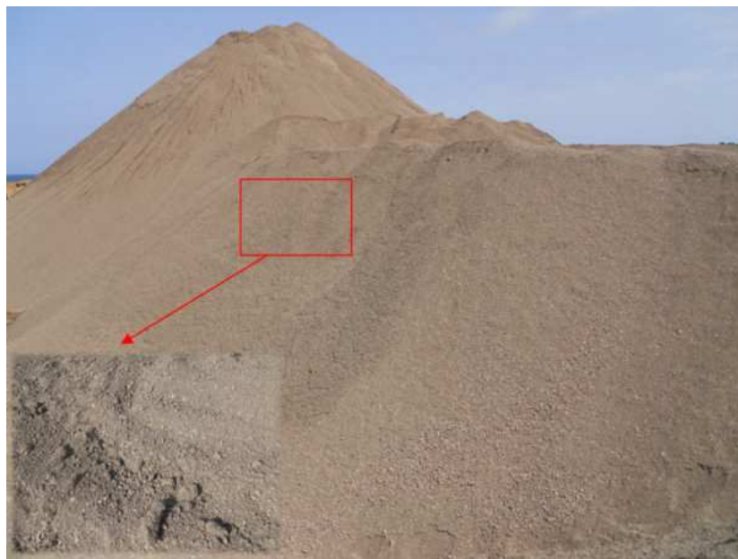
Fig. 21 : Stock de sable destiné au remplissage des geotubes
