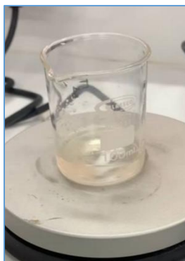
Figure IV.1: Solubilisation du chitosane extrait dans l'acide acétique
