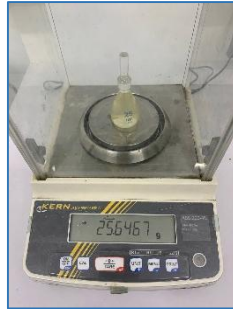
Figure IV.4: Pycnomètre rempli de shampoing lors de la mesure de la densité.
