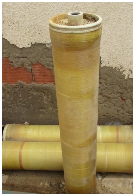
Figure 18 : Modules d'osmose inverse employés à la station de dessalement de Palm-Beach (AA.ADEM, 2017)
