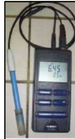
Figure II.12 : pH-mètre de terrain de type (pH/mV mètre, WTW, 197).
