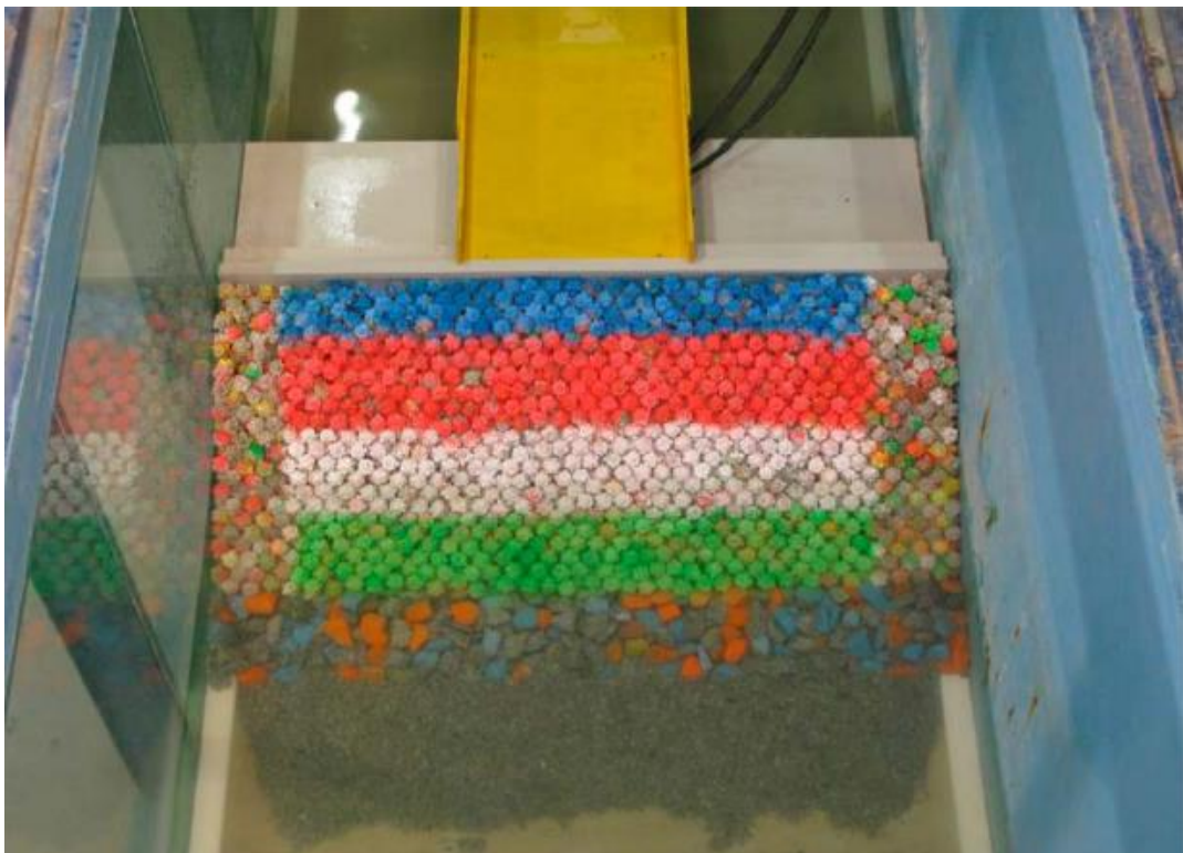
Coupe de la digue après de l'essai, TP=13 secondes (BTP infraestructuras., 2015).
