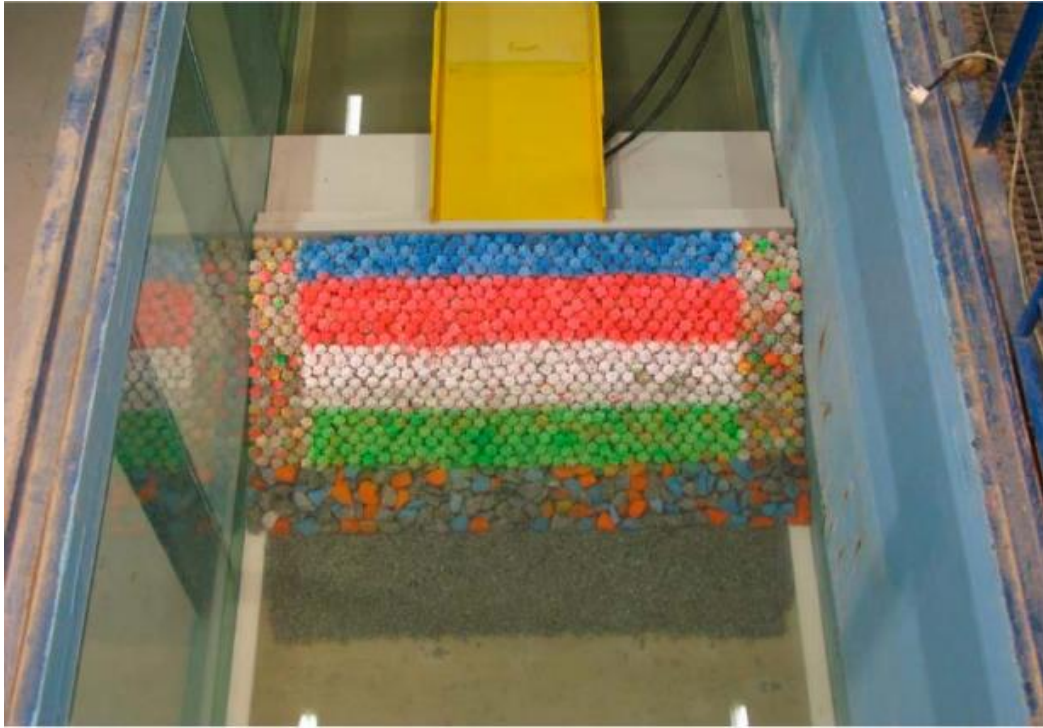
Coupe de la digue avant de commencer l'essai, TP=13 secondes (BTP infraestructuras., 2015).
