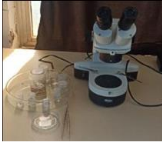
Figure 10: Loupe binoculaire de type OPTICA (Grossissement 4x)
