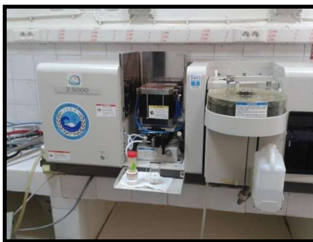
Figure III.3 : Spectromètre d'absorption atomique de marque HITACHI, modèle Z-500
