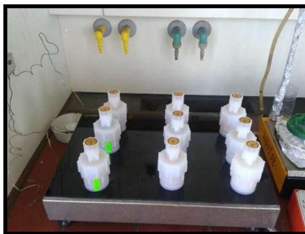
Figure III.2 : minéralisation sur plaque chauffante.
