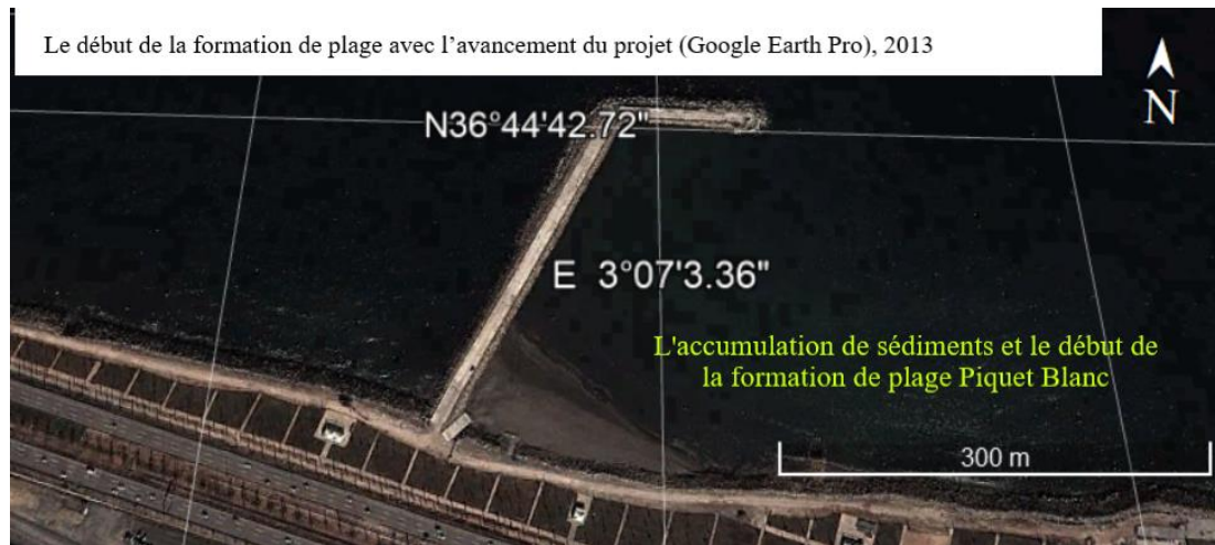
Figure 5: Le début de la formation de plage avec l'avancement du projet (Google Earth Pro), 11/2013
