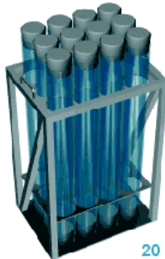
Figure 14: Les tubes PVC de conditionnement des carottes
