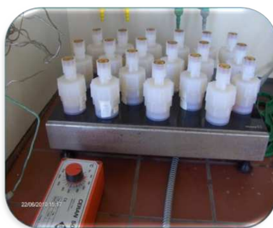
Fig.4 : La minéralisation des échantillons (mise en place des godets sur la plaque chauffante)
