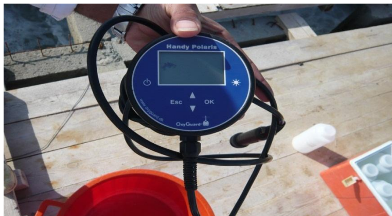
Figure n°16: l'oxymètre de mesure de terrain
