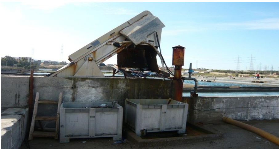
Figure n°8: dispositif de la filtration mécanique
