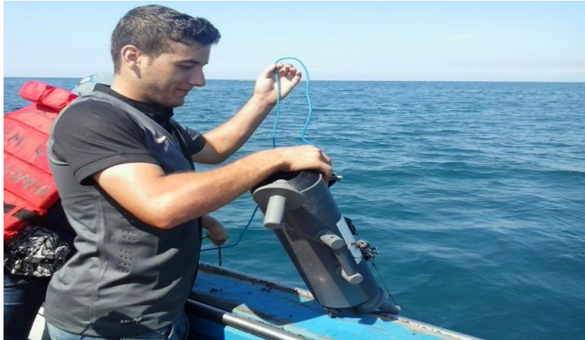
Phot n°5 : La bouteille de prélèvement (Vanveen).
