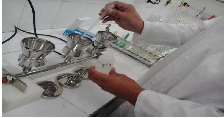
Phot n° 23 : Ajout de quelques gouttes de Carbonate de Magnésium.
