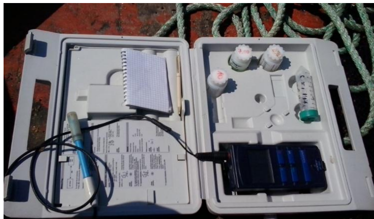
Phot n°8 : pH-mètre et les réactifs de calibrage.
