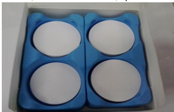
Phot n°19 : Six filtres (membranes de cellulose).
