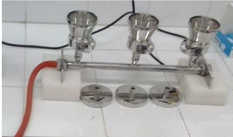
Phot n°12 : Rampe à filtre.
