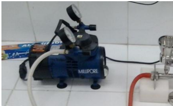
Phot n° 13 : Pompe à air.
