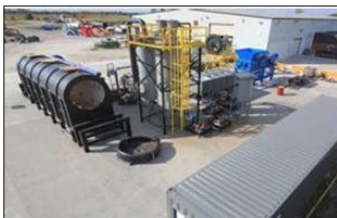
Figure 23 : Four rotatif (dryer drum) de l'unité de désorption thermique et ses caractéristiques
