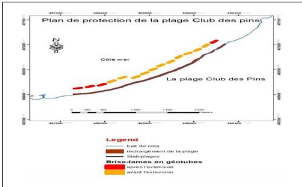
Figure 70: Plan de protection du rivage marin de la plage Club des Pins
