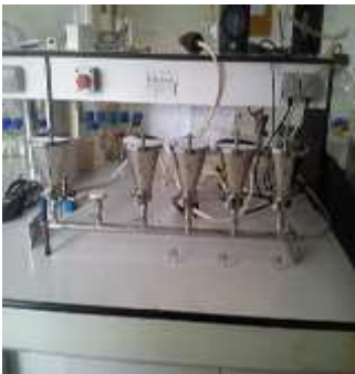
Figure 5 : Rampe de filtration
