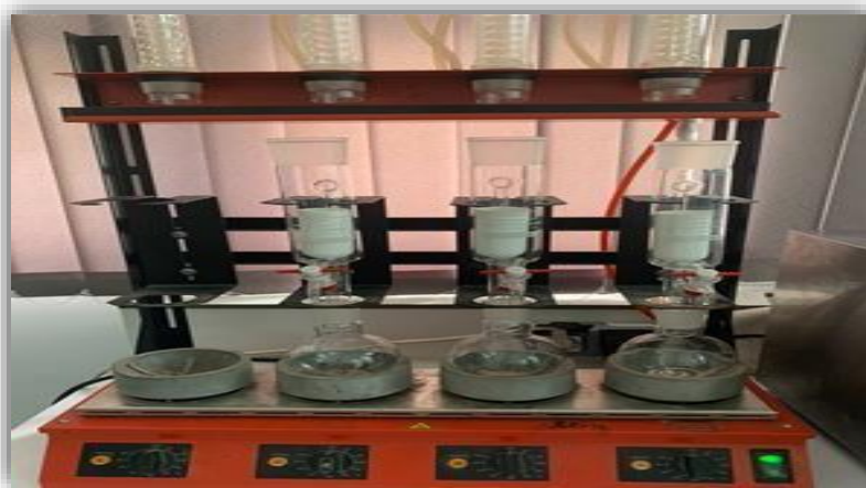
Figure 20. Appareil de Soxhlet pour l'extraction des lipides (Photo originale, 2024)
