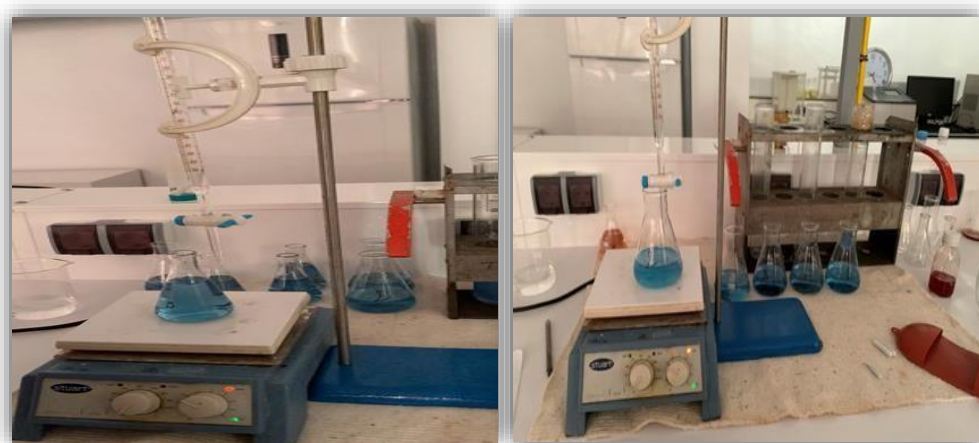
Figure 25. Titrage par \text{H}_2\text{SO}_4 (Photo originale, 2024)
