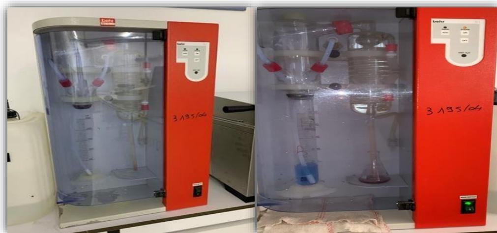
Figure 24. Montage de l'appareil de distillation (Photo originales, 2024)
