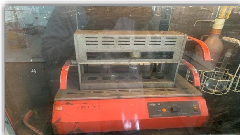
Figure 23. Le digesteur (Appareil de minéralisation) (Photo originale, 2024)
