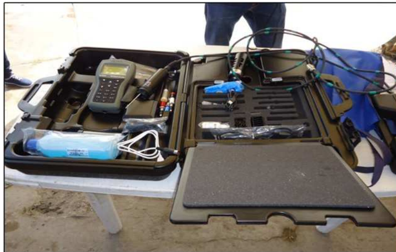
Figure 11 : Valise multiparamètres équipée d'une sonde de type Hanna 9828.
