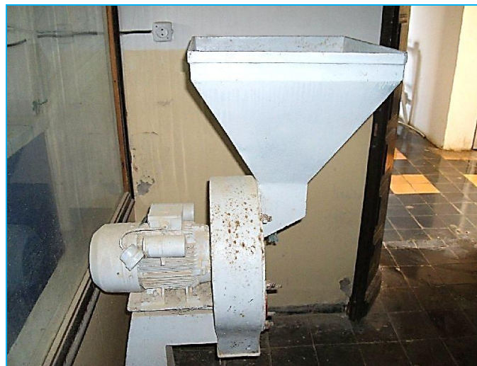
Figure 64 Appareil utilisé pour le broyage des ingrédients
