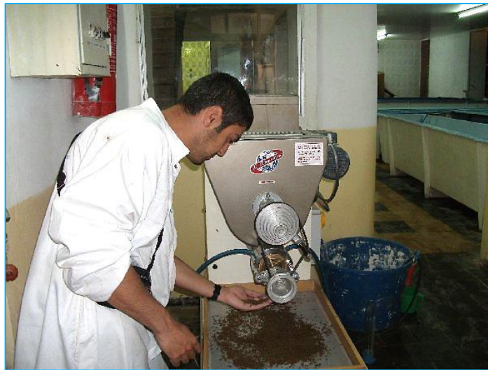
Figure 68 Sortie de la pâte (aliment) après pressage et coupage
