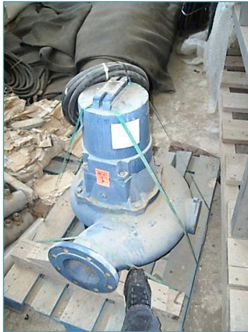
Figure 29 Pompe immergeable pour la diffusion d'oxygène
