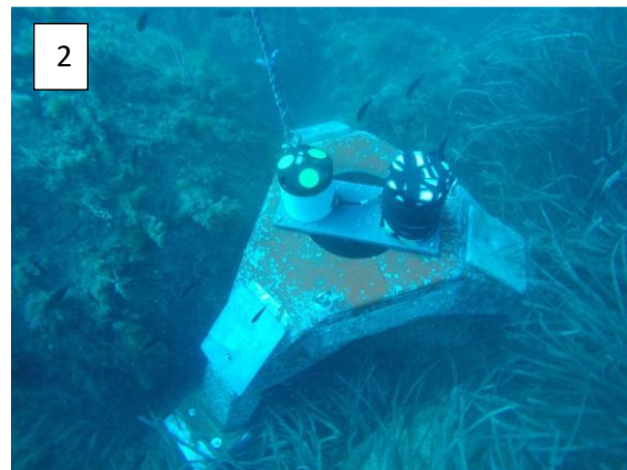
Figure II - 9 Tractage de du support de l'ADCP par l'embarcation l'ADCP fixé sur sa structure en fibre de verre
