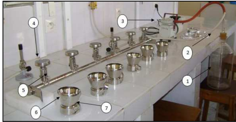
Figure 18 : Dispositif de l'appareil de filtration sur membrane. (Rampe de filtration)
