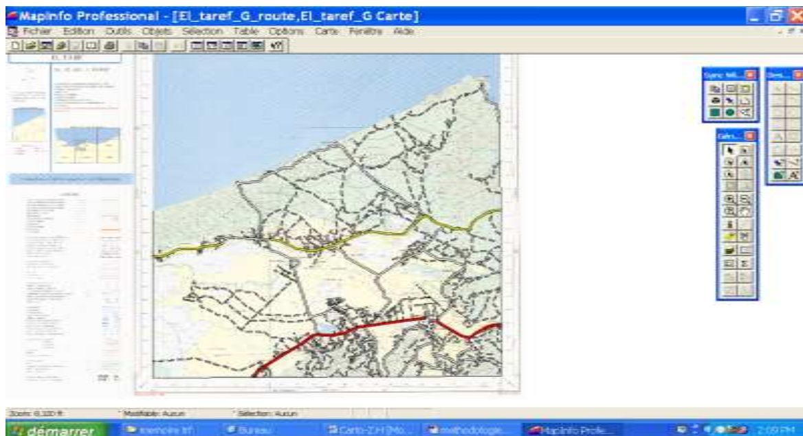
Figure N° 31: Représentation de la couche de dessin du réseau routier sur la carte numérisée d'El Taref Ouest.
