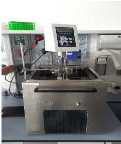
Figure 21 : Photographie d'un viscosimètre rotationnel (VISCO STAR PLUS).
