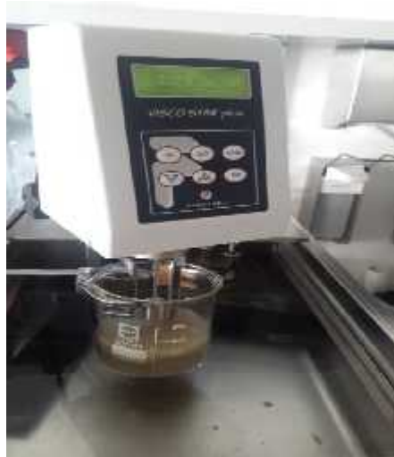
Figure 22 : Mesure de la viscosité de la solution d'alginate de sodium à partir d'un viscosimètre.
