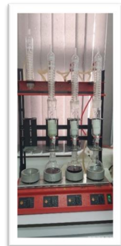
Figure e : Extraction de lipides d' Azolla pinnata à l'aide d'un appareil Soxhlet.
